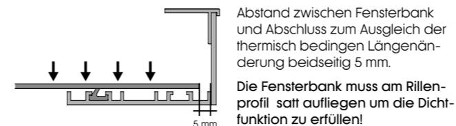
Abstand zwischen Fensterbank und Abschluss zum Ausgleich der thermisch bedingten Längenausdehnung beidseitig 5 mm.
