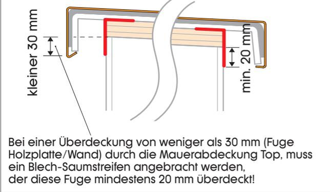
**3. Top Niederhalter, Stoß-/Eckverbinder laut Verlegeplan montieren**
